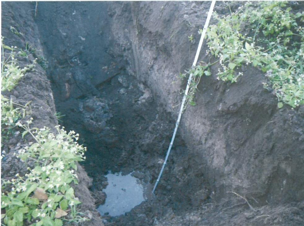
Foto 10. Particolare del fronte di scavo del pozzetto esplorativo P03 che si è spinto fino ad una profondità di 1,6 m dall'attuale piano campagna.
