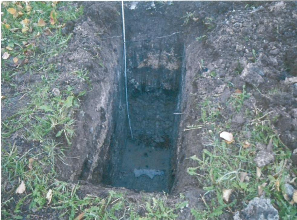
Foto 4. Particolare del fronte di scavo del pozzetto esplorativo P01 che si è spinto fino ad una profondità di 1,8 m dall'attuale piano campagna.
