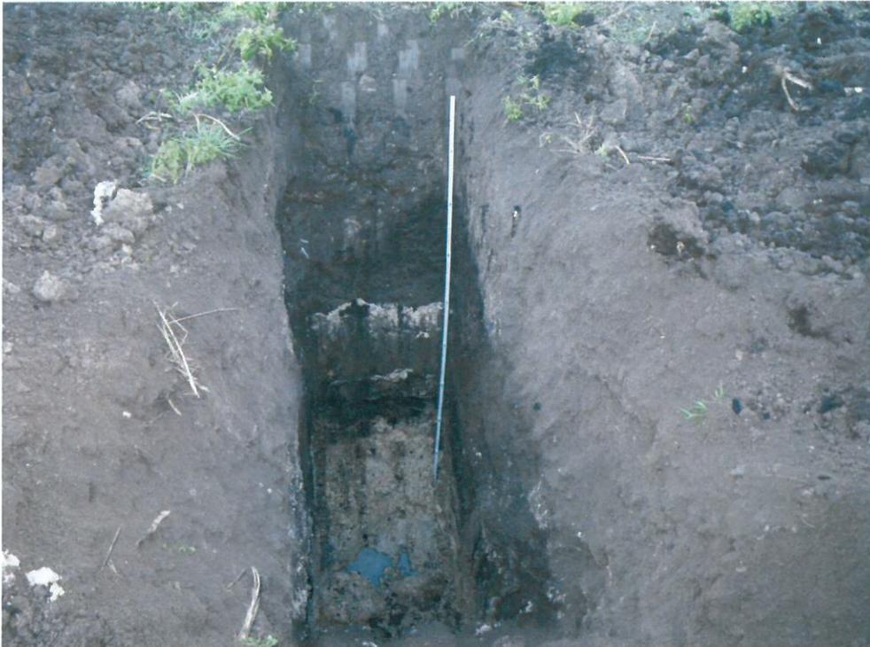
Foto 7. Particolare del fronte di scavo del pozzetto esplorativo P02 che si è spinto fino ad una profondità di 2,0 m dall'attuale piano campagna.
