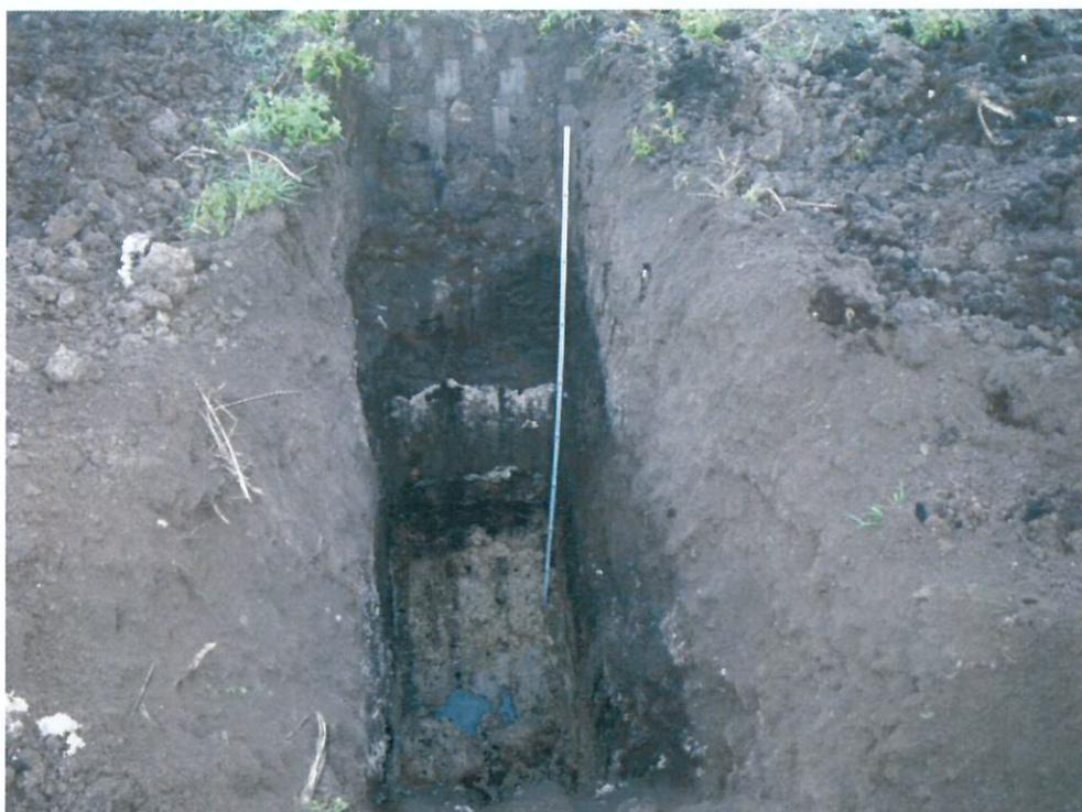
Foto 20. Particolare del fronte di scavo del pozzetto esplorativo P02 che si è spinto fino ad una profondità di 2,0 m dall'attuale piano campagna.
